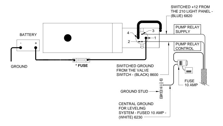
NOTE: IF THE PUMP BRACKET IS WELDED TO THE FRAME, USE THE GROUND STUD TO ATTACH THE THE PUMP TO THE BRACKET. IF THE PUMP BRACKET IS BOLTED TO THE FRAME, USE THE GROUND STUD TO ATTACH THE BRACKET TO THE FRAME.
